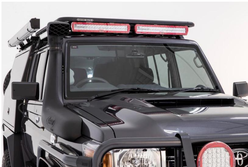
На фото показаны два крепления с двумя фарами AR40
